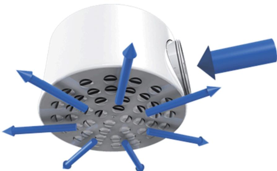
L'air est diffusé dans le local aussi bien horizontalement que verticalement à travers les buses de la façade du diffuseur. Le profil de diffusion de l'air peut être orienté de manière radiale dans les directions désirées en tournant chaque buse à la main. Des profils de flux d'air directionnels ou rotatifs peuvent également être obtenus en réglant les buses.
