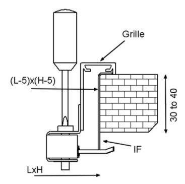
Les fixations à vis cachées de la grille sont compatibles avec le cadre de montage (IF).
