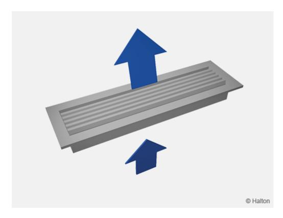
L'air est insufflé dans le local avec une déflexion de 15° à travers les ailettes horizontales. Il se mélange avec l'air ambiant à l'avant de la grille. Le jet d'air peut être dirigé vers le mur pour augmenter la portée de la veine d'air.
