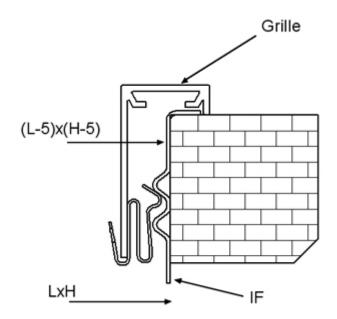
Pour l'utilisation avec les cadres IF, la fixation par clips est standard.
