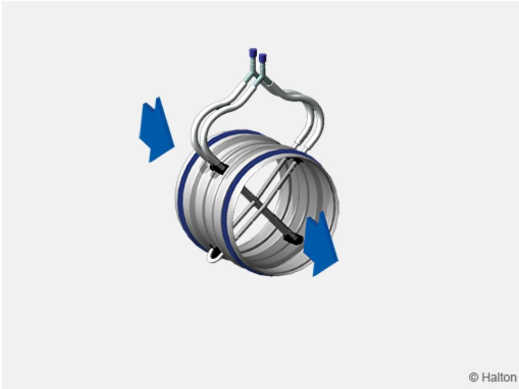
Der Kanalluftstrom erzeugt eine Druckdifferenz zwischen Stirn- und Endseite der Messfühler. Die zwei Sätze der Messfühler überkreuzen sich und haben eine gleichmäßige Perforation zur Mittelwert bildenden Druckmessung. Die Luftströmungsrate ist relativ zur Quadratwurzel des Differenzdrucks.
