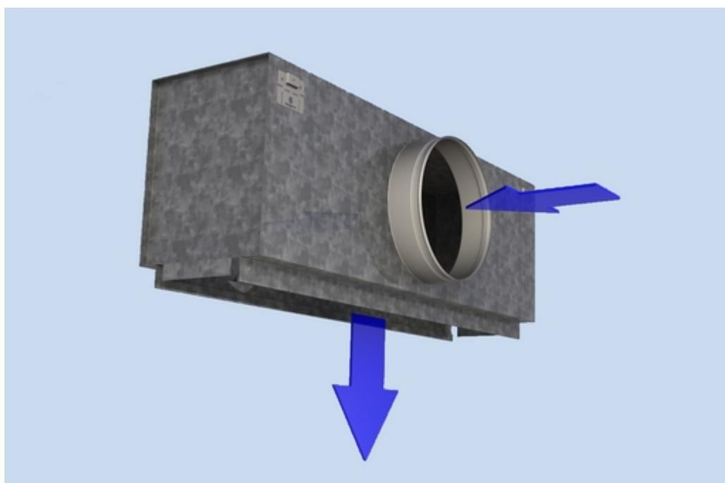
La pression et la vitesse de l'air diminuent en traversant le plénum Halton PLM. L'air est insufflé dans le local à travers le diffuseur et assure une bonne distribution de l'air.
