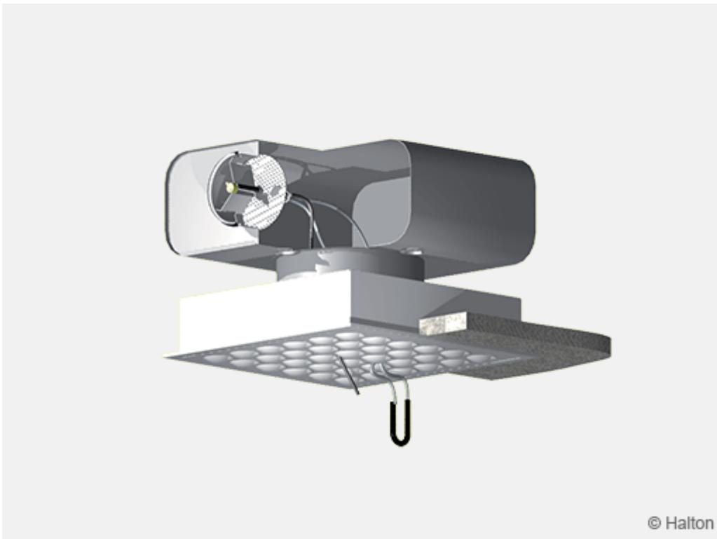
Le débit de soufflage est déterminé au moyen du module de mesure et de réglage du débit MSM. Faire passer les tubes et la tige de commande à travers le diffuseur. Mesurer la différence de pression avec un manomètre différentiel. Le débit d'air correspondant est calculé selon la formule ci-dessous
