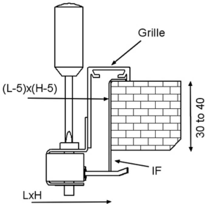
Eine verdeckte Schraubbefestigung ist möglich, wenn das Gitter mit einem Montagerahmen (IF) oder einem Halton BDR-Anschlusskasten aber nicht mit einem Halton PRL-Ausgleichanschlusskasten installiert wird. Bohrungen für die Schrauben befinden sich in der Halton BDR.
