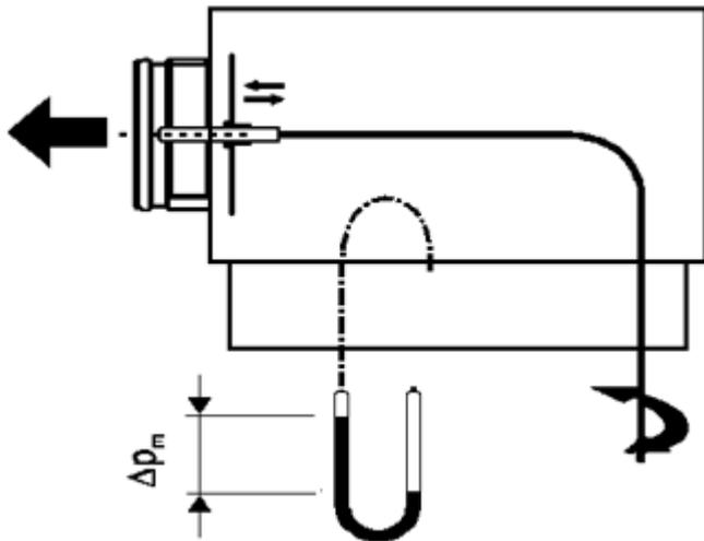
Um eine Einstellung und Messung der Luftströmungsmenge vorzunehmen, wird empfohlen, den Luftauslass an den Halton BDR- oder Halton PRL-Anschlusskasten mit der MSM-Einheit anzuschließen. Die Zuluftströmungsmenge wird mit der MSM Mess- und Regeleinheit eingestellt. Nehmen Sie das Gitter ab und führen Sie die Schläuche und Einstellspindel durch das Gitter. Messen Sie den Differenzdruck mit einem Manometer. Der Volumenstrom wird mit Hilfe der unten stehenden Formel kalkuliert.
