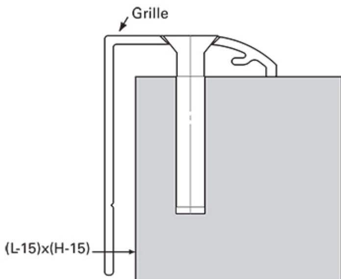
Für eine Deckenmontage empfehlen wir eine sichtbare Schraubbefestigung. Schrauben, 4,2×25 (Flachkopfschraube) werden mitgeliefert.
