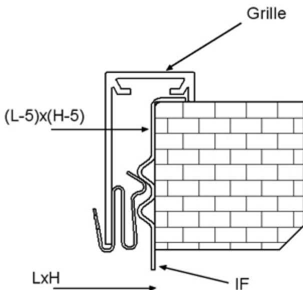
Die Gitter werden standardmäßig mit einer Klemmfederbefestigung geliefert. Die Klemmfederbefestigung wird mit Halton PRL, Halton BDR und IF eingesetzt.
