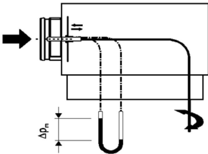
Berechnen Sie die Luftströmungsmenge durch Messung der Druckdifferenz zwischen dem Messnippel am Halton PRL- oder Halton BDR-Anschlusskasten und der Raumluft. Die entsprechende Luftströmungsmenge wird berechnet und durch Drehen der Einstellspindel an der Regeleinheit MEM justiert.
