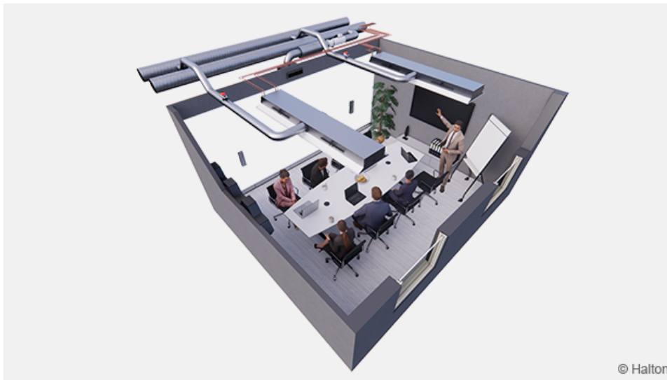
Kuva 16. Aktiiviset Halton Rex RE6 -ilmastointipalkit, joissa on HAQ-säädin ja PTS-säätöpelti, ja niitä ohjataan Halton Workplace WRA -huoneautomaatioyksiköillä
