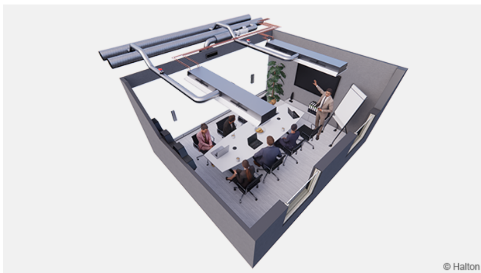
Fig. 16. Halton Rex RE6 aktiva kylbafflar med HAQ-styrning och PTS-spjäll som regleras med styrenhet Halton Workplace WRA för rumsautomation
