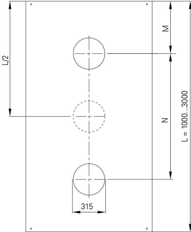
以下尺寸仅为单模块烟罩的尺寸。大型烟罩可通过单模块烟罩组合进行组装，以便于运输和现场操作。
