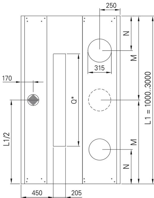
以下尺寸仅为单模块烟罩的尺寸。大型烟罩可通过单模块烟罩组合进行组装，以便于运输和现场操作。
