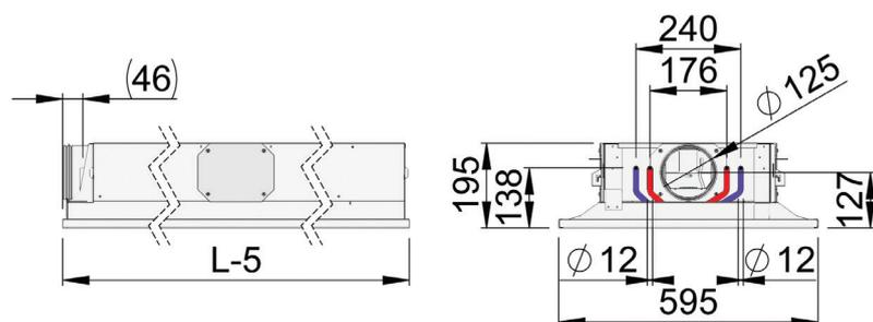
Longueur totale 1200 à 2400 mm; batterie haute efficacité, double circuit (CE=H2)
