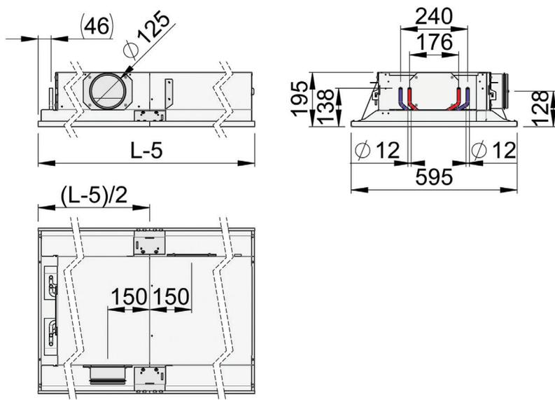
Longueur totale 1200 à 2400 mm; batterie haute efficacité, double circuit (CE=H2)
