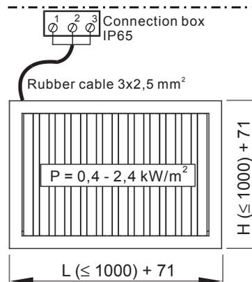
Les connexions électriques doivent être faites au moyen d'un boîtier de raccordement. Entre la grille et le boîtier de raccordement se trouve un câble de caoutchouc de deux mètres de long.
