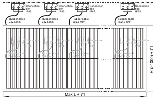
Dans le cas d'un montage modulaire, chaque module possède son propre boîtier de raccordement. Cela doit être pris en compte lors de l'établissement des plans électriques.
