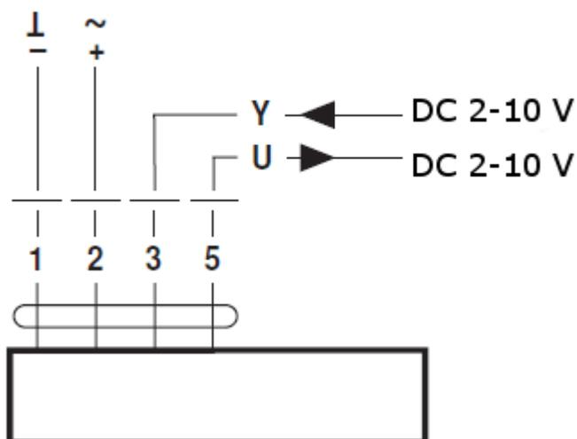
Avec un signal de commande 10 V, le registre de réglage est complètement ouvert.
