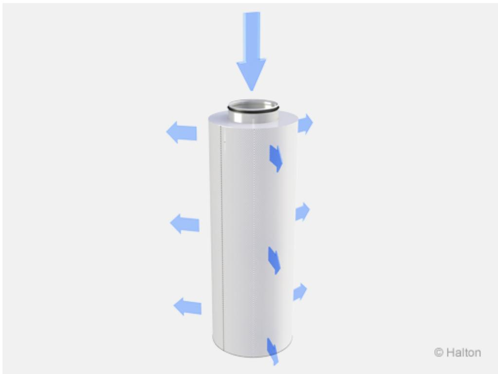
L'air est diffusé uniformément dans la pièce à travers la façade du diffuseur Halton Zen Circle, à une température habituellement légèrement inférieure à celle de la pièce (1 à 5°C).
